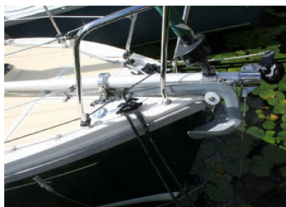
Een forse boegspriet schuift door ringen op het voordek en onder de roltrommel van de fok.
