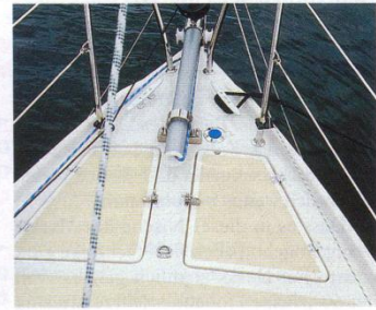
Volles Rohr: In der Spiere läuft eine Leine, die den Rüssel nach vorn zieht
