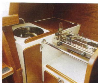
Klapp-Ecke: Drei kleine Mahagonischapps wurden von Hand in die Pantry gebaut
