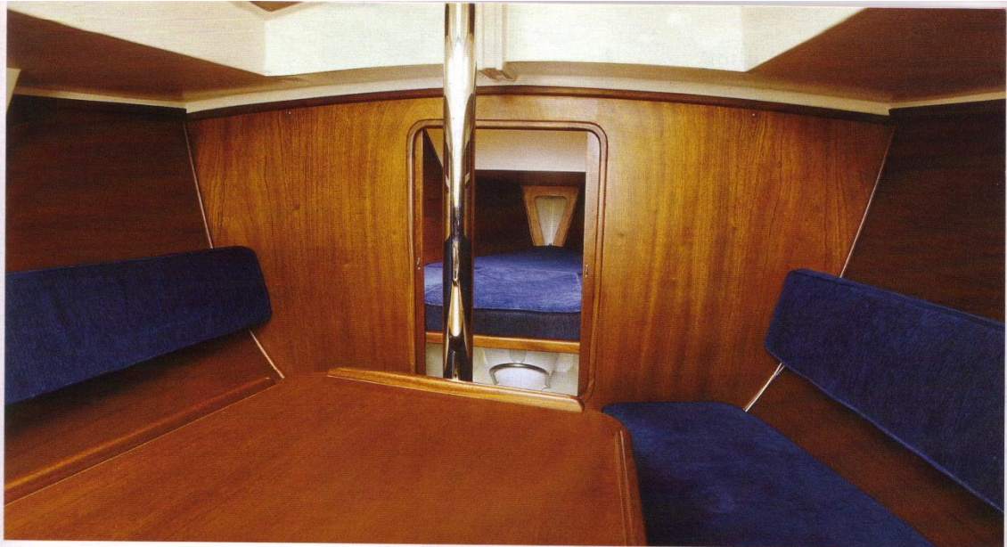
Mahagonihöhle: Lediglich die Salondecke ist aus GFK. Eine Schiebetür im Schott teilt das Vorschiff ab. Mehr Stauraum wäre möglich
