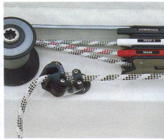
Doppelte Bedienung: Die Stagsegelschot wird via Winsch oder Klemme bedient
