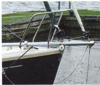
Kurzer Rüssel: Um den Klüver komplett zu bergen, wird der Bugspriet eingefahren
